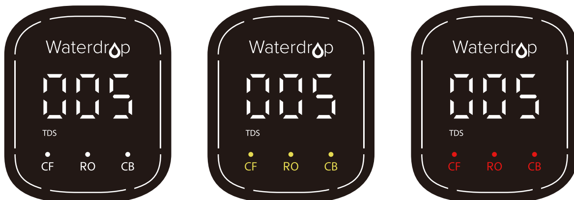
Przykłady wskaźników kranu: stan prawidłowy, zbliża się wymiana, wymień teraz.
